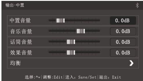
按【▲】，【▼】切换光标，旋转编码器【EDIT】调整参数值。按【SAVE/SET】进入子菜单，均衡操作与音乐均衡操作相同。按【EXIT】返回输出菜单。
