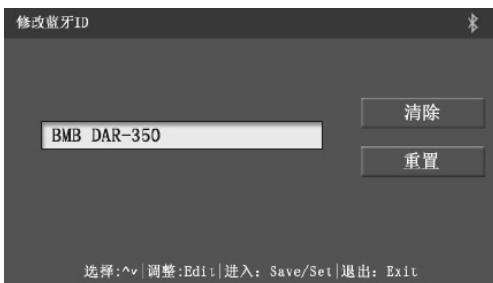
当光标在ID时按【SAVE/SET】进入ID修改模式，【▲】，【▼】可以修改ID字符位置，旋转编码器【EDIT】编辑字符。
