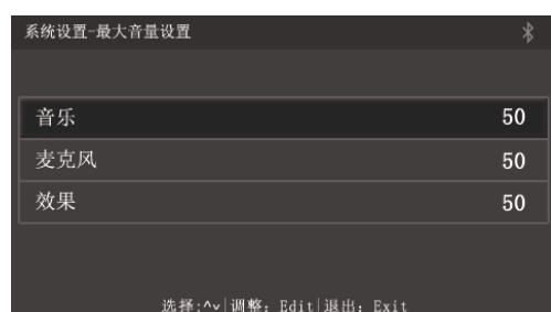
设置可调节的最大音量值，限制最大音量。
