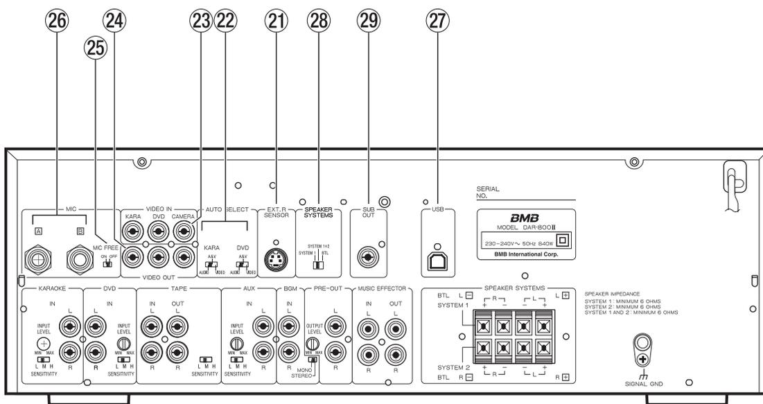
**21 Terminal de EXT(ernal) REMOTE SENSOR (sensor remoto de conexión externa)**
