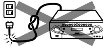
Cuando desconecte el cable de alimentación de la toma de corriente alterna, por favor sostenga y tome la punta de enchufe y no acarrar el cable de alimentación, ya que el deterioro del cable de alimentación posiblemente ocasionará el cortocircuito o la descarga eléctrica. Debe evitar colocar el cable de alimentación por debajo de los muebles o en aquellos lugares donde el cable de alimentación posiblemente sufrirá algún daño.
