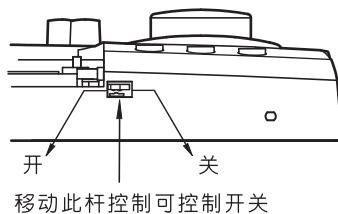
在开处时：压控制片右侧可开启控制片。
