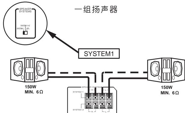
注意：在SYSTEM 1模式请勿连接下端插孔
