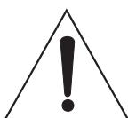
一个等腰三角形的里边有一个惊叹号表明，警告附在装置上的印刷品上有重要操作和维修指导（服务）。
