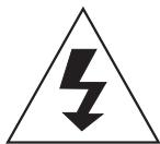
一个三角形的图形里边有一个闪电形的箭头表明，警告设备里面有未绝缘的危险电压存在，该电压将足够让人有触电的危险。
