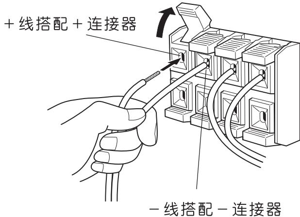
作连接前，先用钳子剥去导线端外皮约15mm长。
