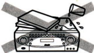
切勿由开口处将任何种类的物体掉入本装置，因为它们可能碰触具有危险的电压点或使电路短路，而引发火灾或是电击。切勿让任何液体流入本装置。如果有物体或液体掉落，请从交流电源插座取下电源线，并请教您当地的经销商。
