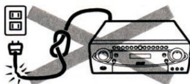
从交流电源插座取下电源线时，务请抓握与拉扯插头部分而非电线部分。电源线受损可能导致短路或电击。电源线应勿安置在家俱下面或是电源线可能受损的地方。
