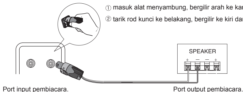
Gambar sirkuit skematis pembiacara.
