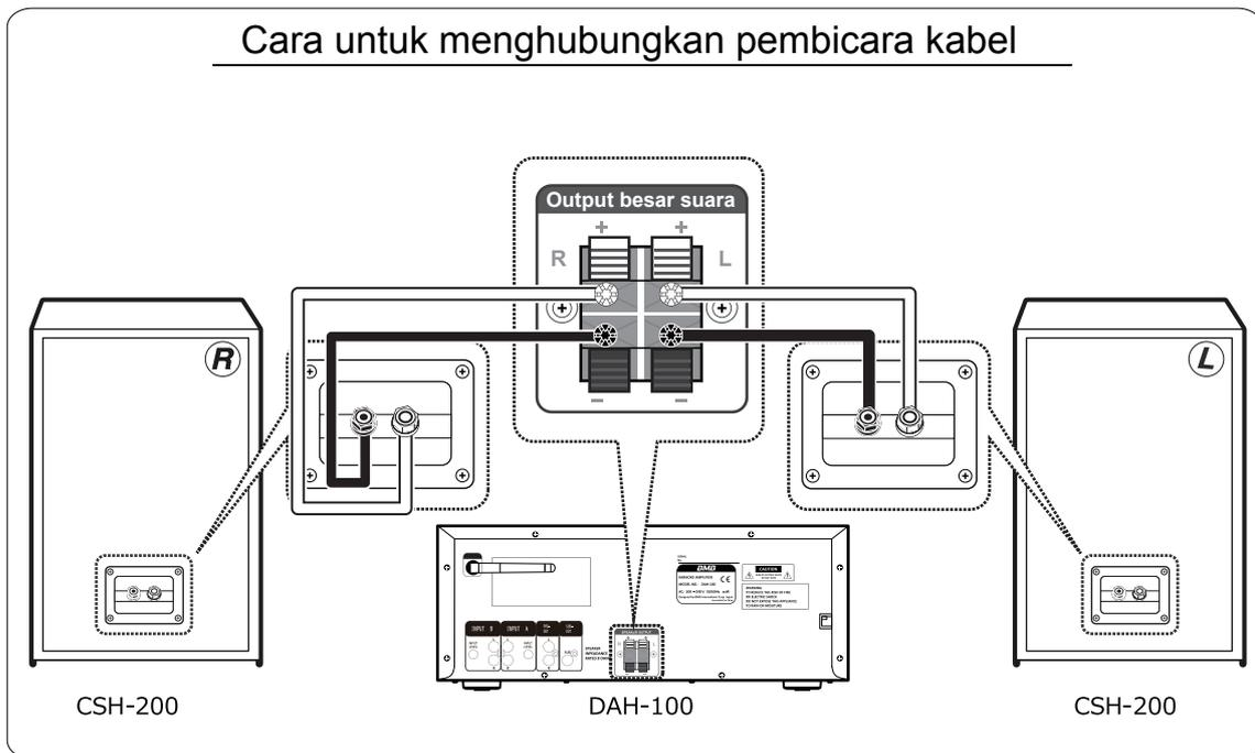
Pertimbangan untuk menghubungkan pembicara kabel
