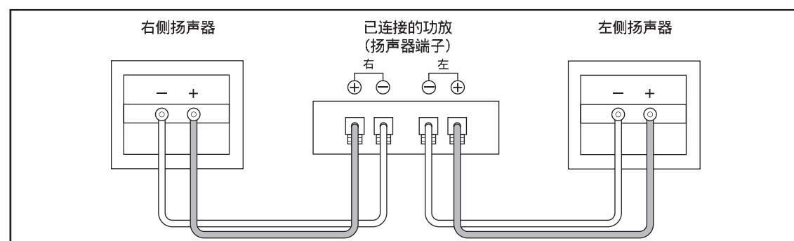
\* 如果左右扬声器的极性连接不正确, 则再现音质、环境气氛和方向感将受到明显的影响。
